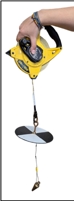
Disque de Secchi pour mesurer la turbidité (transparence) de l'eau.
