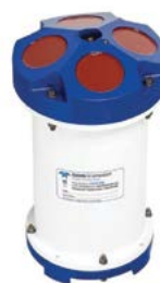
Un exemple d'ADCP semblable mais utilisé en limnologie. Crédit photo : Unique Group
