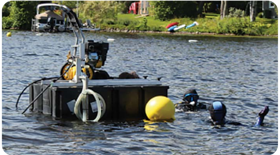
Aspirophylle - équipement spécialisé aidant les plongeurs lors de l'arrachage manuel du MAÉ
